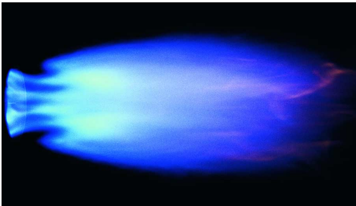
Flamme d'un brûleur gaz Weishaupt en exécution LN (LowNO x )
