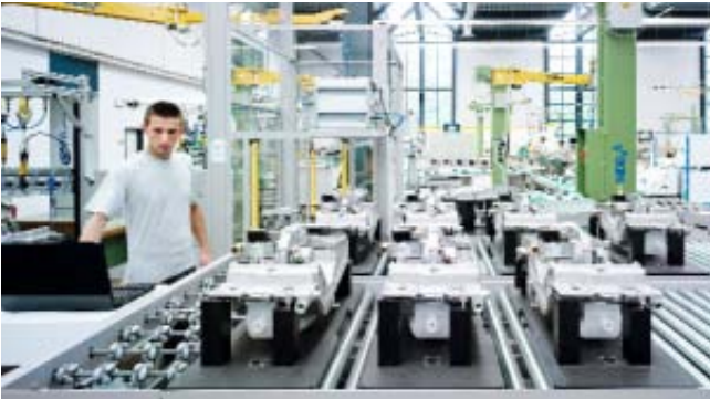
Produktion im schweizerischen Werk Sennwald: Hier werden Wärmetauscher für die Brennwertgeräte in Serie gefertigt.
