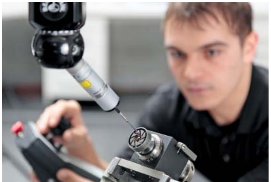
Feinjustierung im Werk Schwendi: Zusammenspiel von elektronischer Messtechnik und Augenmass – hier bei der Vermessung einer Wirbelplatte für die Ölzerstäubung.
