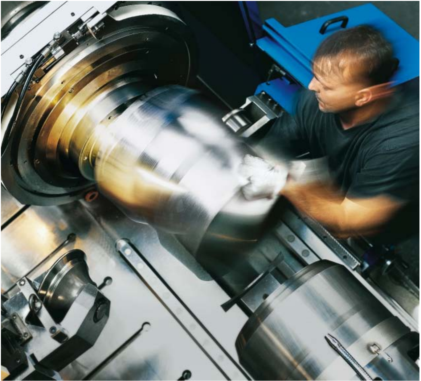
Hightech-Produktion Schwendi: Ein präzise geformtes Flammrohr für einen Industriebrenner wird aus der Drückmaschine genommen.
