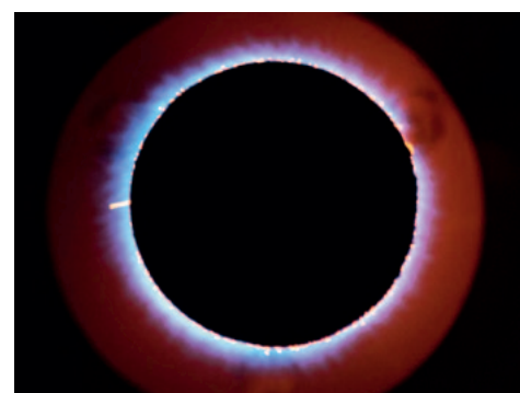
Palniki Weishaupt PLN mogą być stosowane również w bardzo wąskich komorach spalania
